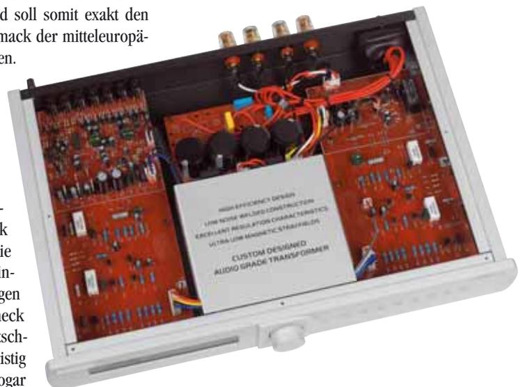
**Blitzsauberer Schaltungsaufbau im Verstärker V-100: sorgfältig verlegte Kabel und ein zusätzlicher Abschirmdeckel über dem Ringkerntrafo**
